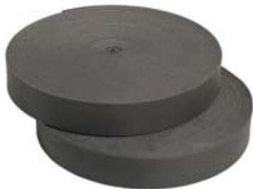
Talotiiviste ja routamatto on valmistettu umpisoluisesta ristosilloitetusta PEX-vaahdosta. Polyeteeni ei ime kosteutta joten talotiiviste soveltuu hyvin mm. sokkelin ja alaohjauspuun väliseksi eristeeksi. Routamattoa käytetään mm. valu- ja routaeristeenä, sekä suurten lämpöputkien eristeenä.
