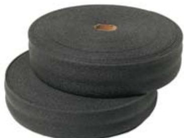
Irrotuskaista ja pakkasmatto on valmistettu umpisoluisesta PEX-vaahdosta. Irrotuskaistaa käytetään lattiavalun ja sokkelin välissä. Pakkasmattoa voidaan käyttää mm. valun kuivumisajan pakkaseristeenä.
