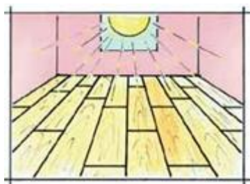
Asenna laudat päävalon suuntaisesti.
